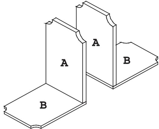
Die **Ecken der Grundplatten und der Seitenwände nach Abbildung** mit der Laubsäge **formen**.
