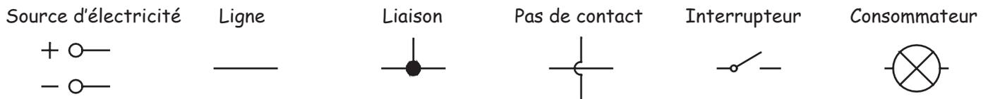
Pour représenter le cheminement du courant électronique dans le circuit électrique ainsi que les différents composants on utilise des symboles de commutation simples.
