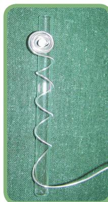
3. Placer l'éprouvette à la verticale et enrouler le fil alu autour de la pierre.
