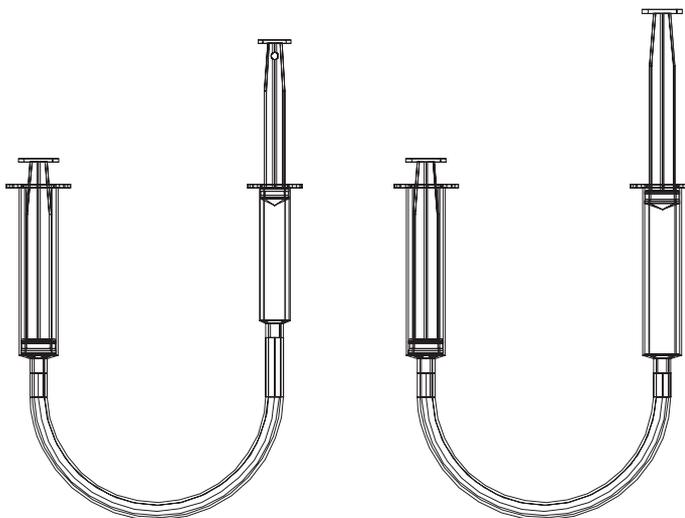
**6. MONTAGE DU SYSTEME HYDRAULIQUE :****Système 1 - Pelle ouvrir / fermer - Long. tuyau 1250 mm**
