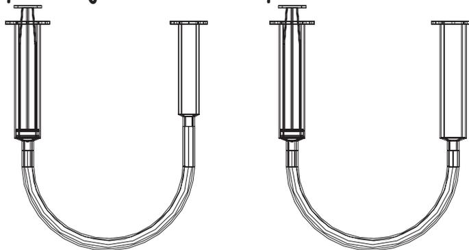
4. Remets en place le piston sur l'autre extrémité.
