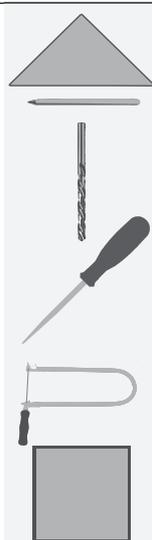
Reproduis les gabarits sur les contreplaqués (240 / 90 / 6 mm) (180 / 150 / 4 mm). Perce dans les pièces (C), (D) et (B) un **trou  $\varnothing 3$  mm**. Marque l'endroit pour le piton sur la pièce (E) à l'aide du **poinçon** et d'un crayon. Découpe les différentes pièces avec la **scie à chantourner** et ponce tous les **bords de coupe avec le papier abrasif**.
