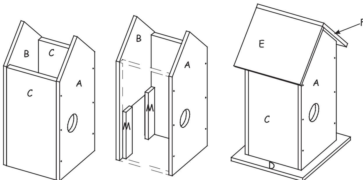
D'abord coller et clouer les pièces (A) (B) (C) puis les pièces (M) et pour finir la **base** (D) et le **toit** (E) (F).
