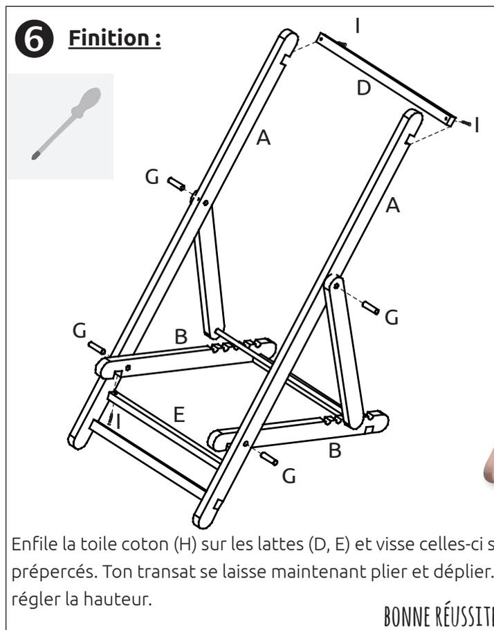
Enfile la toile coton (H) sur les lattes (D, E) et visse celles-ci sur les pièces (A, B). Insère les chevilles (G) à travers les trous prépercés. Ton transat se laisse maintenant plier et déplier. Grâce aux encoches dans les parties (B) tu peux également régler la hauteur.
