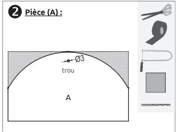
Avec les ciseaux, découpe grossièrement le **gabarit** de la pièce (A) et fixe-le avec du ruban transparent sur le contreplaqué.
