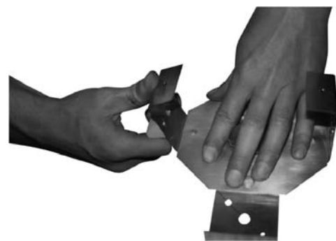
Plier les parois latérales à angle droit vers le haut
