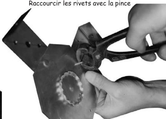
Raccourcir les rivets avec la pince
