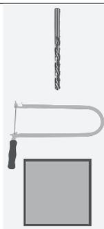
Perce les **trous  $\varnothing 3,5$  mm** dans la pièce (B). Découpe la forme selon le schéma, avec la **scie à chantourner** et ponce tous les **bords avec le papier abrasif**.
