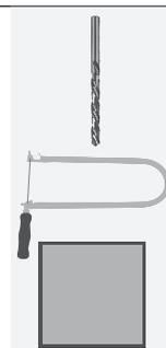
Perce **10 trous  $\varnothing 6,5$  mm** avec une profondeur de 10 mm dans les **deux lattes (A) (480 / 50 / 15 mm)**. Reporte également le biais et la **courbure des plans 1 et 2 sur les pièces (A)** et découpe-les avec la scie à chantourner. Ponce tous les **bords avec le papier abrasif**.
