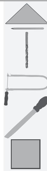
Dessine les formes des **deux côtés latéraux selon la gabarit** sur les deux lattes en bois (A1, A2) (165 / 85 / 15 mm). Pour pouvoir scier le **trou de la poignée avec la scie à chantourner**, il faut d'abord percer un trou **Ø 4 mm**. Enfile alors la lame de scie et découpe. Ponce tous les bords avec du papier abrasif.
