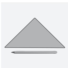
Place les motifs de **ton serre-livres** sur les plaques de contreplaqué de 4 mm (C). Les contours du gabarit doivent correspondre à ceux de la plaque de contreplaqué !!! **Trace ensuite les lignes avec un stylo à bille**. Tu dois bien appuyer pour que les formes s'impriment sur le contreplaqué. **Trace encore une fois les lignes sur le contreplaqué à l'aide d'un crayon**. Les lignes seront ainsi bien visibles.
