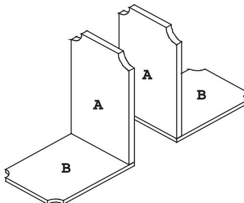
Formez les coins des plaques de base et des parois latérales avec la scie à chantourner selon l'illustration. Si l'on visse (selon le groupe d'âge) : percer deux trous dans chaque surface de base. **Coller les bases et les parois latérales ensemble comme illustré ci-dessus et éventuellement les visser** (selon le groupe d'âge).
